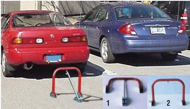
**1 BR131 BARRIERA ANTISOSTA** abbatte e lucchettabile, da fissare a pavimento con asta telescopica di rinforzo. Utile per riservare il posto auto ed efficace contro il furto dell'auto parcheggiata. Costruita in tubo di acciaio Ø 40 mm verniciato, con piedini e asta in acciaio zincato. Colore rosso.
