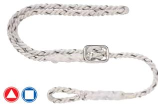
**6 CS3112 CORDINO DI POSIZIONAMENTO - EN358** Fune poliammide a 3 trefoli Ø 12 mm. Fibbia di regolazione in lega leggera. Lunghezza max 1,5 m.
