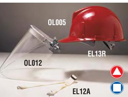
**EL13R ELMETTO "ERCOLE"** In policarbonato termoplastico altamente resistente all'impatto. Prestazione inalterata da +130° a -40° C. Bardatura interna regolabile con fascia antisudore. Peso 340 g. Resistenza a 440 Volt.
