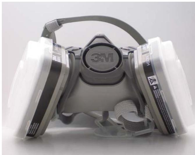
**SEMIMASCHERE 3M™ Serie 6000. Respiratori riutilizzabili a bassa manutenzione che offrono semplicità e comodità.** La struttura a due filtri riduce la resistenza respiratoria, facciale morbido e leggero in materiale elastomerico, ipoallergenico, sistema 3M™ di innesto dei filtri a baionetta, comoda bardatura e facile chiusura della fibbia. **Conformi alla norma EN 140.**
