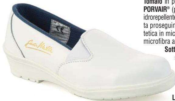
**Tomaio** in pelle pieno fiore con trattamento speciale **PORVAIR®** (per settore agro-alimentare) antibatterico, idrorepellente e oleorepellente, colore bianco; linguetta proseguimento del tomaio. **Fodera** anteriore sintetica in microsoft antisudore. **Fodera** posteriore in microfibrina antisudore e antimicotica.
