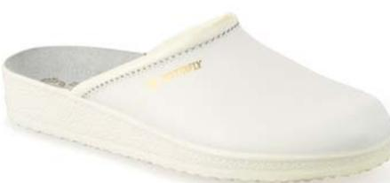
Calzatura da lavoro. Lavorazione ad iniezione diretta della suola. **Suola** in poliuretano espanso monodensità, antiscivolo. **Assorbimento** di energia nella zona del tallone (E). **Tomaio** in pelle crosta ricoperta in poliuretano. **Bordino** imbottito sul collo del piede. **Fodera** anteriore in TNT. **Sottopiede** in pelle crosta colore ghiaccio.
