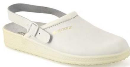
Calzatura da lavoro. Lavorazione ad iniezione diretta della suola. **Suola** in poliuretano espanso monodensità, antiscivolo. Assorbimento di energia nella zona del tallone. **Tomaio** in pelle crosta ricoperta in poliuretano. **Bordino** imbottito sul collo del piede. **Fodera** anteriore in TNT. **Sottopiede** in pelle crosta colore ghiaccio. **Cinturino** bloccatallone in pelle, con fibbia.
