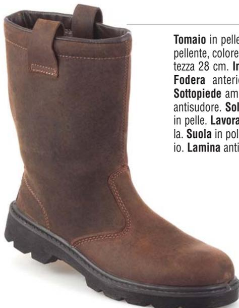
**Tomaio** in pelle fiore bovina idrorepellente, oleorepellente, colore marrone, con effetto "PULL UP", altezza 28 cm. **Interno** rivestito in pelliccia sintetica. **Fodera** anteriore sintetica in TNT antisudore. **Sottopiede** amovibile in Cambrelle® antimicotico e antisudore. **Soletta** in Texon antistatico. **Tallonetta** in pelle. **Lavorazione** ad iniezione diretta della suola. **Suola** in poliuretano bidensità. **Puntale** in acciaio. **Lamina** antiperforazione in acciaio.
