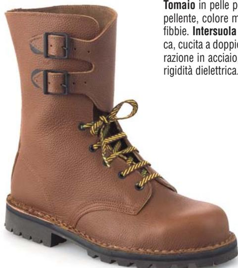
**Tomaio** in pelle pieno fiore idrorepellente e oleorepellente, colore marrone. **Chiusura** con lacci e due fibbie. **Intersuola** in cuoio. **Suola** in gomma nitrilica, cucita a doppio filo. **Puntale** e **lamina** antiperforazione in acciaio, rivestiti con un materiale a forte rigidità dielettrica.
