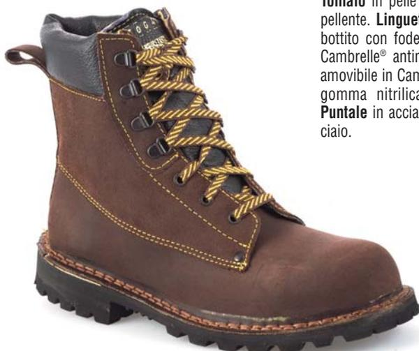
**Tomaio** in pelle stampata idrorepellente e oleorepellente. **Linguetta** imbottita. **Bordo** superiore imbottito con fodera in pelle pieno fiore. **Fodera** in Cambrelle® antimicotico e antisudore. **Sottopiede** amovibile in Cambrelle®. **Soletta** in cuoio. **Suola** in gomma nitrilica ALPEX, cucita a doppio filo. **Puntale** in acciaio. **Lamina** antiperforazione in acciaio.
