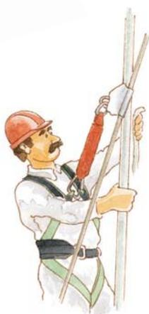
**Asta telescopica e connettore**. Per fissare temporaneamente una linea su fune flessibile verticale ad un punto di ancoraggio difficilmente raggiungibile.
